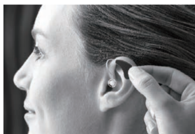
大分類としては「耳掛け型」。業界ではRIC(リック)と呼ばれます。鼓膜面の近い位置にレシーバを配置できたため、小型化が同時に実現されました。
