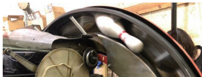
③その後ピンは水車のような機械でもち上げられ、レーンにならんだピンの上に運ばれる。
